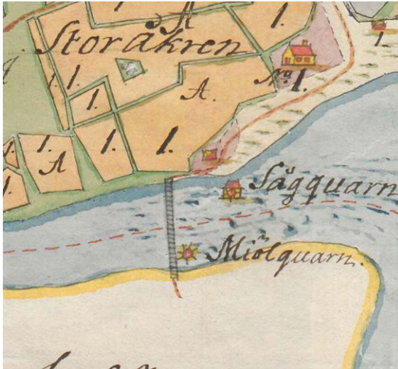
Kuva 115. Vantaan Tolkinkylän maanomistukseen keskittynyttä kartta vuodelta 1751 kuvaa joki-uomaa varsin niukasti. Vesisaha (sägquarn) on kuvattu rakennuksena ja vesimylly (miölquarn) vain vesirattaan symbolina. Vesivoiman käyttöön liittyviä rakenteita ei ole kuvattu. Liki saman aikainen Vantaanjoen vesistökartta (1757-1760) antaa paikasta hyvin erilaisen kuvan (ks. kuva 34). Paikalla on ollut ylivirtauspato, jonka päissä ovat sijainneet myllyn ja sahan vesikanavat. Padon alapuolella uoma on vähävetinen, ja uomassa on paljon kuivilla olleita saarekkeitä. Kartta: Kansallisarkisto, Maanmittaushallituksen uudistusarkisto, MHA U, B11b:3/4-5 Tolkinkylä / Tolby [1751-1751].
