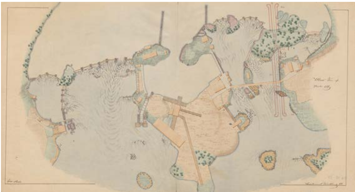
Kuva 46. Joensuun Utran 1830-luvulla valmistunut sulkukanava (Arppen kanava) oli puurakenteinen. Kosken keskisaaren läpi kulkeva kanava on kuvattuna noin vuoteen 1845 ajoittuvaan karttaan. Kartassa esitetään myös kalapadot ja vesisahoja. Oikeassa reunassa näkyy punaisella uuden venekanavan suunnitelma (Myllykylä 2011). Kartta: Kansallisarkisto, Tie- ja vesirakennushallituksen vesiosaston kartat ja piirustukset, TVH EI 87:/- -_21 30 b3.
