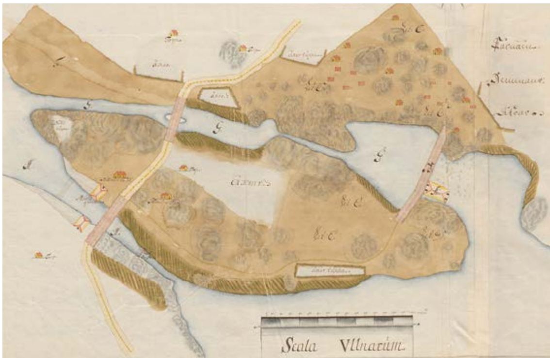
Kuva 33. Helsingin Vanhankaupunginkosken länsihaaran myllyjen yhteydessä ollut pohjapato (vas.) on kuvattuna vuoden 1738 kartassa rantamyllyjen vesikanavien väliin sillasta ylävirtaan. Kartta: Kansallisarkisto, Maanmittaushallituksen uudistusarkisto, MHA U, B7Helsinki:33/3-4 Viikin latokartano / Viks ladugård [1738].
