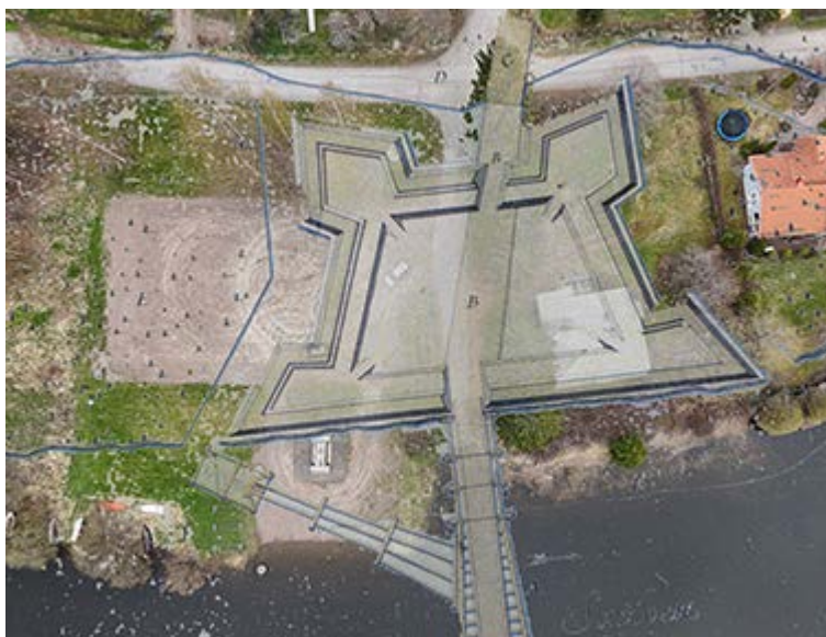
Kuva 112. Ruotsalaiset rakensivat pienen maavalleilla varustetun linnoituksen eli skanssin Kymijoen itärannalle Ankkapurhasta alavirtaan. Osa vuonna 1742 tuhotusta skanssista on yhä osin säilyneenä. Kuvassa on ilmakuvaan päälle asemoituna vuoden 1740 skanssia kuvaava kartta. Kohde: Kouvola Inkeröisten lauttaranta skanssi. Kuva: Teemu Mökkönen 2024, AKDG7503:1, Museovirasto.
